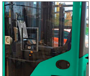
2-suuntainen radiopuhelin kylmävarasto-ohjaamossa
